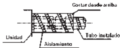
Figura 8. Aplicación del material aislante
